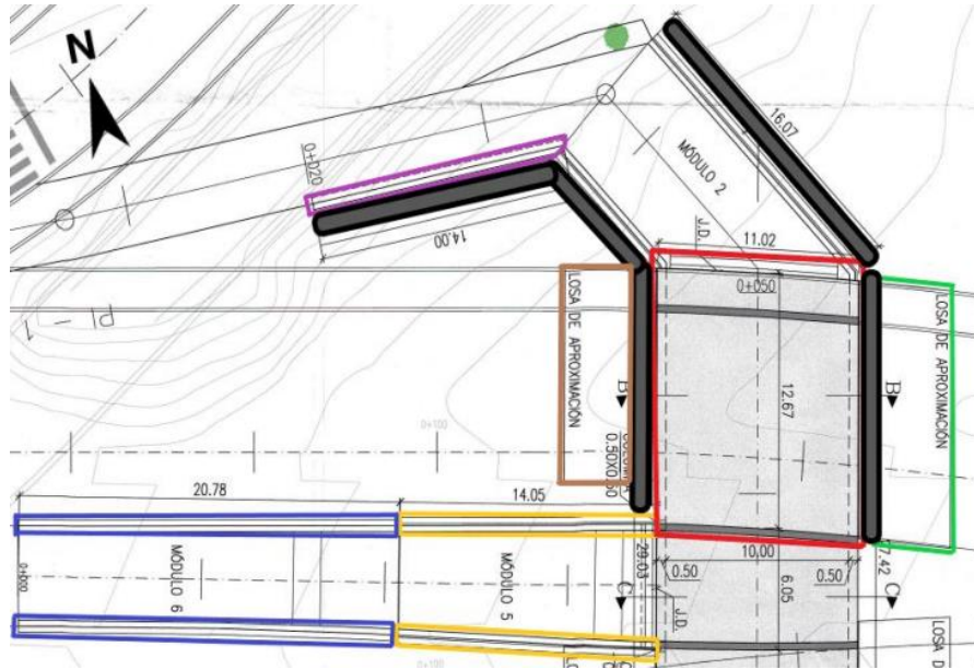
Construcción losa superior en sección norte del box culvert (Ver Zona roja):
